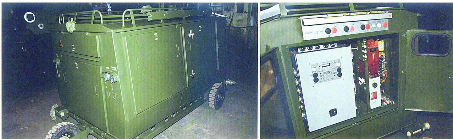
Электроустановка статическая преобразовательная аэродромная переменного тока предназначена для преобразования трехфазного напряжения 380В, 50Гц в переменное напряжение 208 В, 400 Гц и электропитания бортовых систем при наземном обслуживании летательных аппаратов. Электроустановка ЭСПА50Т208 выпускается по техническим условиям в четырех исполнениях:
