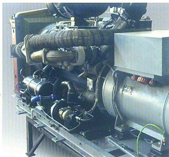
Электростанция передвижная дизельная мощностью 100 кВт третьей степени автоматизации в соответствии с ГОСТ Р 53174-2008 для питания потребителей трехфазным переменным током 400В, 50 Гц.
