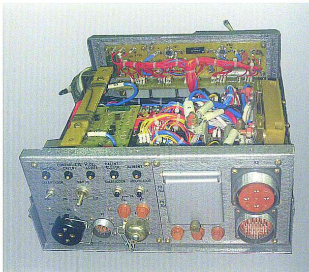
Электроагрегат используется в качестве основного и резервного источника электроэнергии для питания войсковых средств связи и другой специальной аппаратуры постоянным током напряжением 28,5 В при размещении в отсеке транспортного средства на стоянке и во время движения. Мощность 3,5 кВт.
