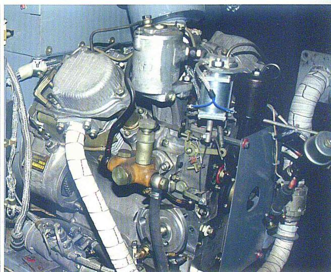
Электроагрегат дизельный постоянного тока второй степени автоматизации мощностью 8кВт предназначен для питания специальной аппаратуры и войсковых средств связи постоянным током напряжением 28,5 В при размещении в отсеке транспортного средства.
